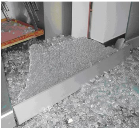
Abb. 1 Schollenbildung nach ESG-Bruch
